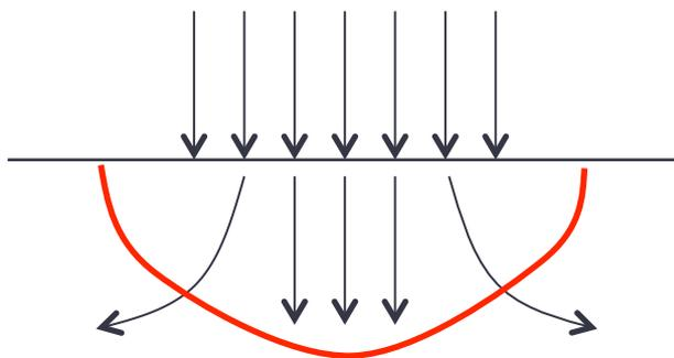
拡散した光も捉えて透過光として扱う
