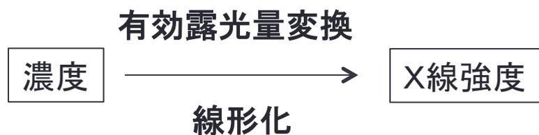
有効露光量: ある濃度を得るのに必要なX線量(露光量)
